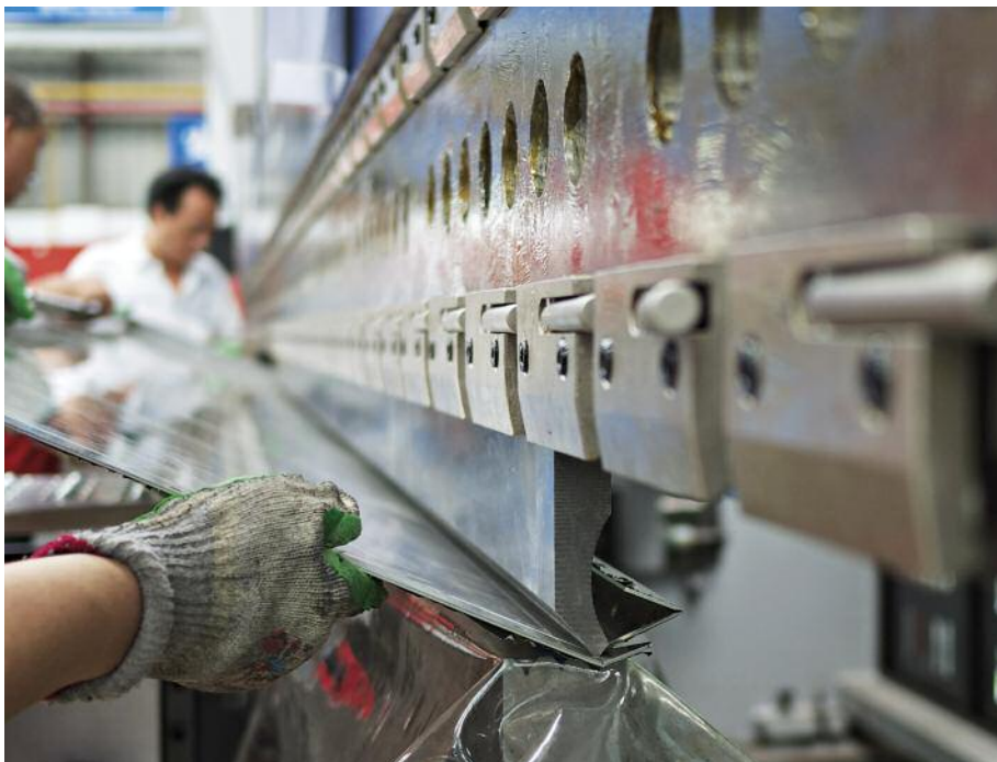
Abkanten von Blech aus nichtrostendem Stahl © IMOA
