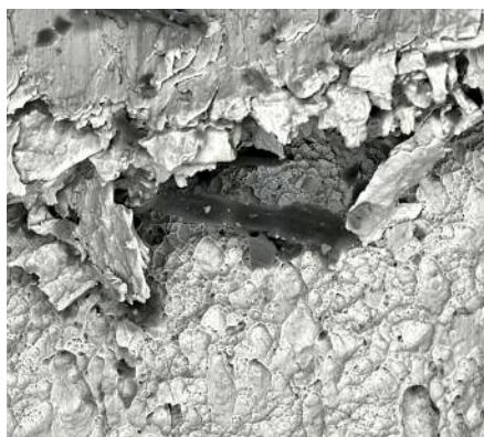
Lochung durch Stanzen mit erkennbaren Glattschnitt- und Bruchflächen: Stumpfe Werkzeuge führten zu rauen Bruchflächen und schuppigen Überlagerungen, die solche Lochungen korrosionsanfällig machen. © Catherine Houska
