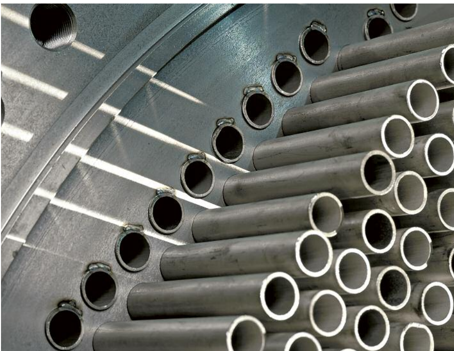
Rohrboden eines Wärmetauschers während der Verarbeitung © Sandvik
