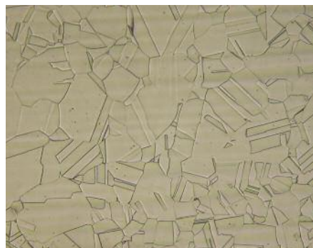
Abbildung 4: Gefüge eines austenitischen Hochleistungsstahls mit 6 % Mo, bestehend ausschließlich aus austenitischen Körnern. © TMR Stainless
