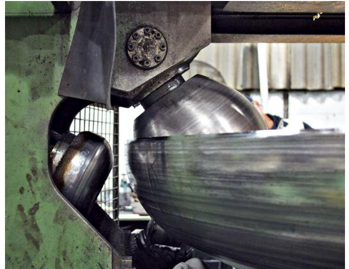
Das Drückwalzen eines Tankkopfes aus austenitischem nichtrostendem Stahl wird durch die große Duktilität des Werkstoffs erleichtert. © IMOA
