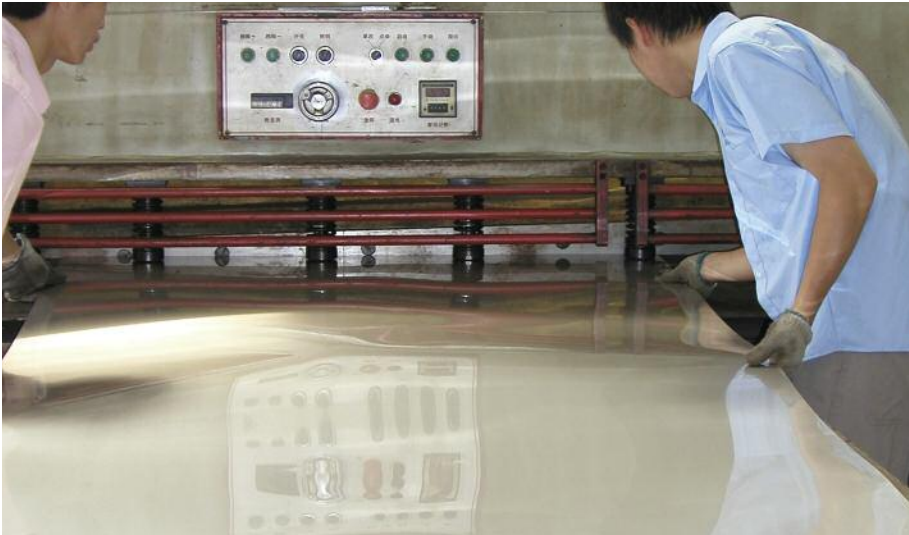
Scheren eines Bleches aus nichtrostendem Stahl © IMO A
