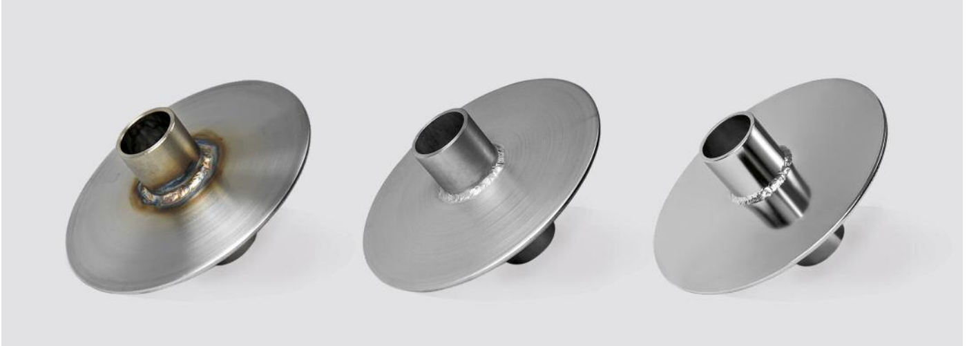
Nachbehandlung eines Schweißteils: Ausgangszustand (links), gebeizt (Mitte), elektroliert (rechts) © Calamo AB
