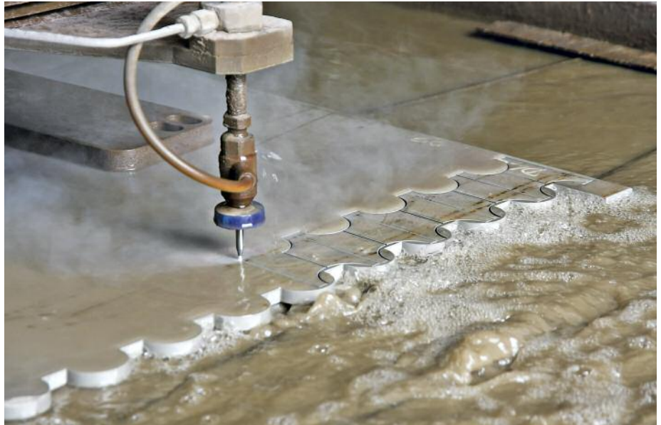
Wasserstrahlschneiden von Grobblech aus nichtrostendem Stahl © Lubos Chlubny/Shutterstock.com
