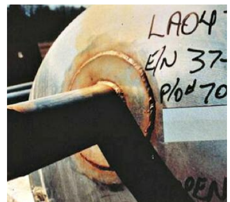
Bürsten aus unlegiertem Stahl können auf nichtrostendem Stahl Verfärbungen und Rost verursachen. © Outokumpu Stainless
