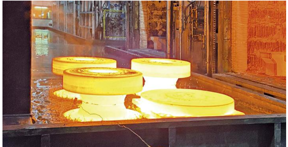
Abschreckung von Schmiedeteilen nach dem Verlassen des Glühofens © Officine Ambrogio Melesi
