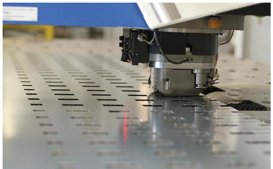
Lochung von nichtrostendem Stahlblech
