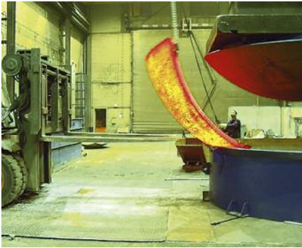
Warmumformung der Segmente eines Behälterkopfes © Antonius Vesselheads BV
