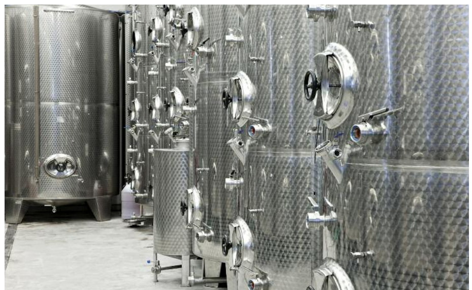
Weintanks werden häufig mit einem „Pfauenauge-Schliff“ versehen. Er ist hygienisch, leicht zu reinigen, optisch ansprechend und lässt Beulen und Kratzer optisch zurücktreten. Die Oberflächenausführung ist ein wichtiger Aspekt des Planungsprozesses. © iStock.com/Josef Mohyla
