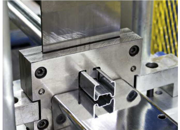
Profil aus nichtrostendem Stahl beim Auslauf aus dem Rollumformer © Warut Sintapanon/Dreamstime.com
