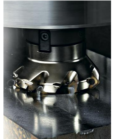
Planfräsen von austenitischem nichtrostendem Stahl mittels eines eingespannten Hartmetallwerkzeugs © Seco Tools
