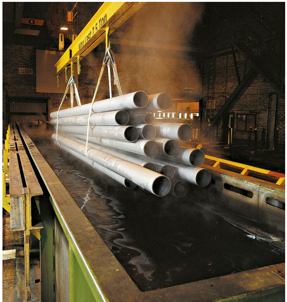
Das Entfetten der Oberfläche ist ein entscheidender Reinigungsvorgang, der jeglicher Wärmebehandlung vorgeschaltet werden muss. © Sandvik
