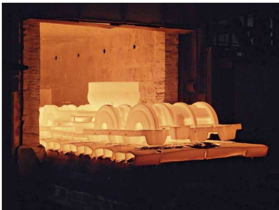
Wärmebehandlung von Teilen aus nichtrostendem Stahl im Chargenofen © Fondinox
