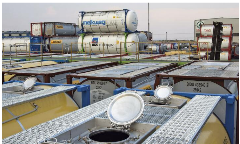
Intermodale Tankcontainer werden zumeist aus nichtrostendem Stahl AISI 316 (EN 1.4401) hergestellt. Durch Kaltumformung werden sie in ihre zylindrische Form gebracht. © IMO A
