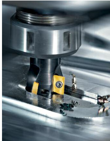
Stirnfräsen mit einem Hartmetall-Werkzeug © Seco Tools
